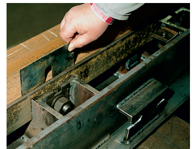
Hinterlegen eines Ausgleichsbleches
