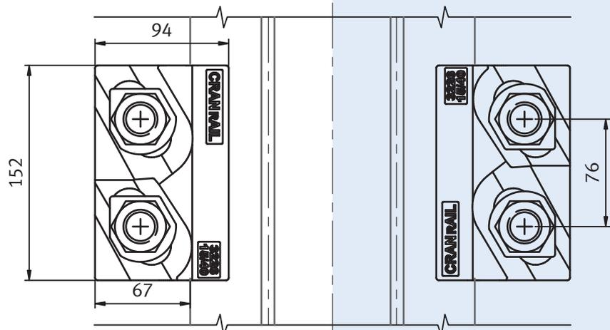
Minimale Einbaubreite – W = Schienenfußbreite (F) + 150mm
